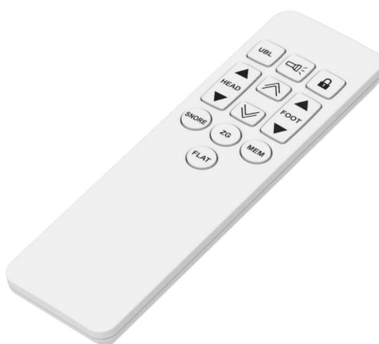
TX32是一款蓝牙无线遥控器，有13个按键，可驱动2推杆，并具有4个快捷键可记忆指定位置。TX32本身有手电筒功能，也可控制外接床底灯，适用于家具床领域。
