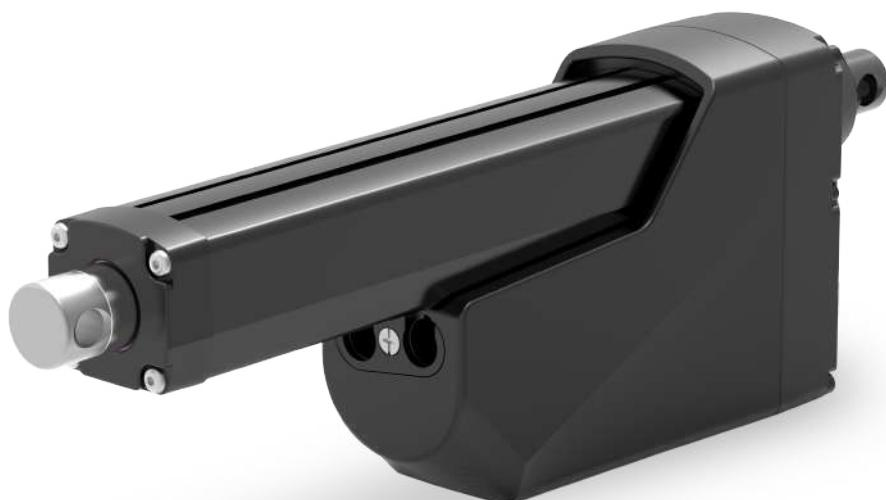
MK35L源自MK35推杆，配置直流无刷电机和更坚固的滚珠丝杆组件，提供25mm/sec的恒速和高达10,000N的负载能力。它具有与MK35推杆相同的外壳和外观以及相同的防护等IP66M/IP67, IPX9K。结合无刷电机驱动器的内置控制板，采用与MK35系列推杆相同的马达线和接线方式。低电流信号控制选项和CAN总线选项(SAE J1939或CANopen通信协议)可搭配用户的应用，例如农业、建筑和工业自动化。
