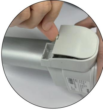
3. 将钢索穿过安装孔的凹槽，并确认钢索圆柱形尾端确实卡入位置，然后，调整钢索护套，使其留在安装孔中。如果使用两根释放钢索，请重复该过程。
